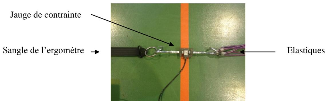
Figure 5 : Jauge de contrainte installée sur l'ergomètre
