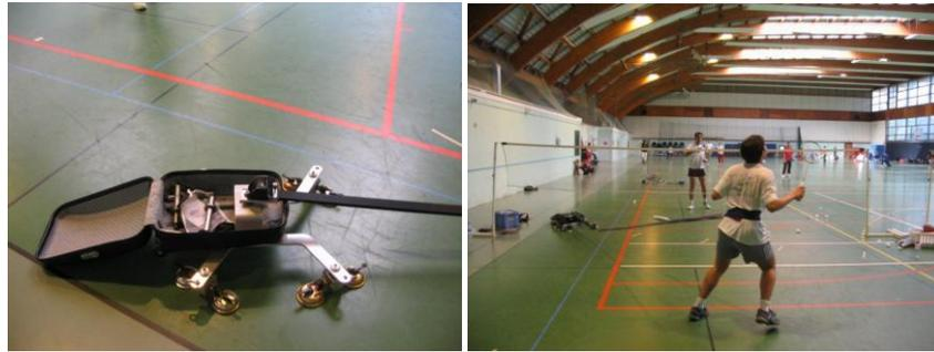
*Figures 1 et 2 : L'ergomètre « badlastic » (source SSU Nantes)*
