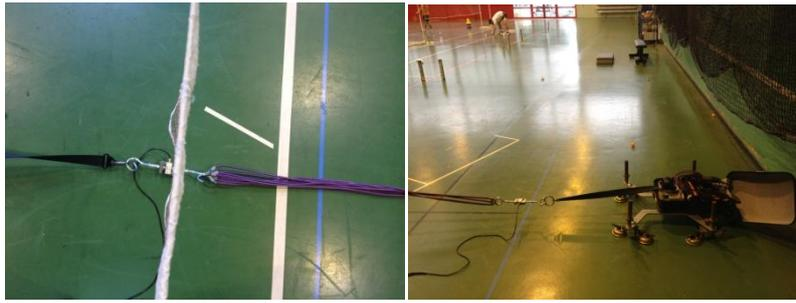
Figures 9 et 10 : position de la jauge de contrainte selon la situation (arrière et avant)
