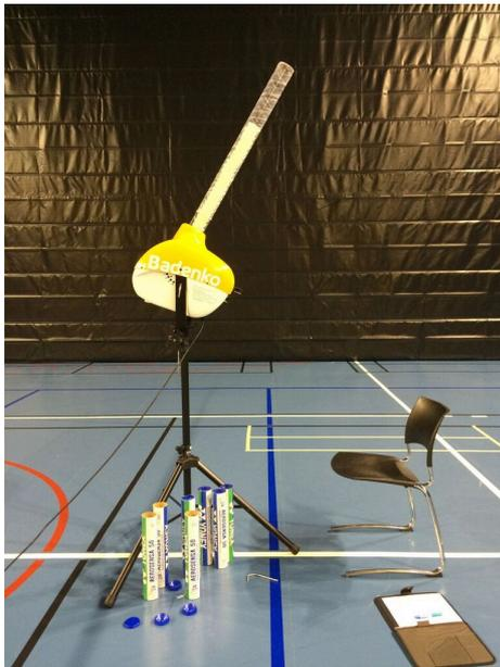
Figure 3 : Lanceur de volant BKL
