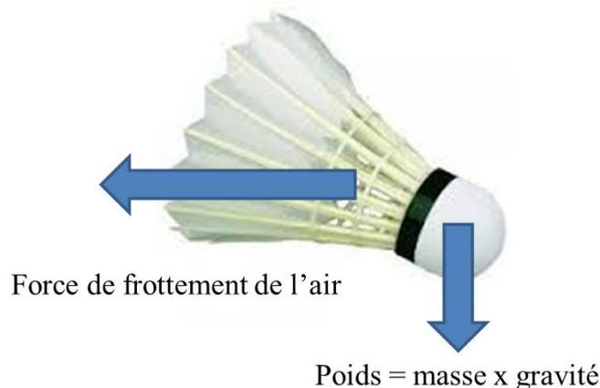
FIGURE 1.3 – Application des différentes forces sur un volant
