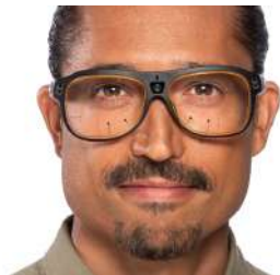
(c) Eye-tracker mobile binoculaire simple, modèle Tobii Pro Glasses 3
