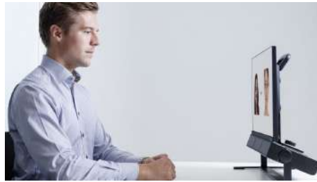
(a) Eye-tracker fixe simple, modèle Tobii Pro Spectrum
