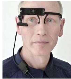
(b) Eye-tracker mobile monoculaire simple, modèle Pro de Pupil Labs
