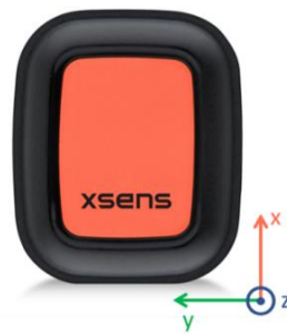
Figure 2 : Le Xsens Dot et son référentiel propre
